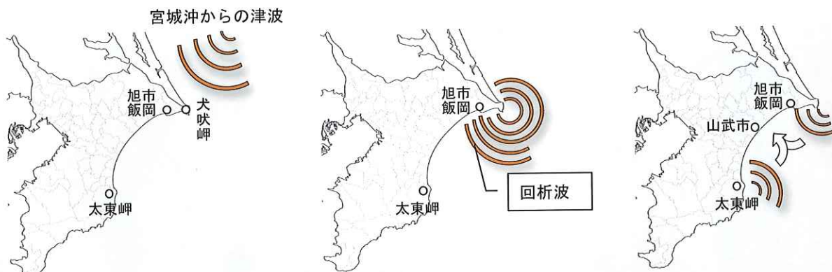
回折波のメカニズム：犬吠埼のような尖った突端に津波が当たると、その波が海岸線に沿って行く現象
