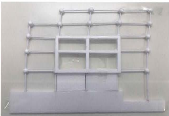
(3)補強部材を設置した場合の横揺れに対する変形
