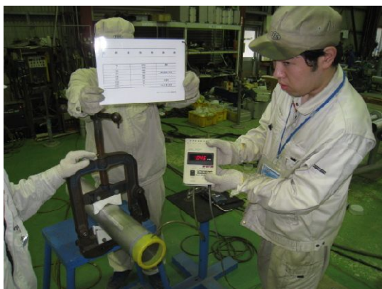
TIG溶接の酸素濃度管理 ステンレス溶接加工の品質を徹底して管理する
