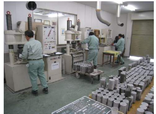
試験機で、コンクリート供試体の圧縮強度試験実施中
