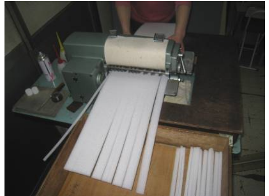
NNソフトロックウールのバックアップ材が正確な寸法で切断される
