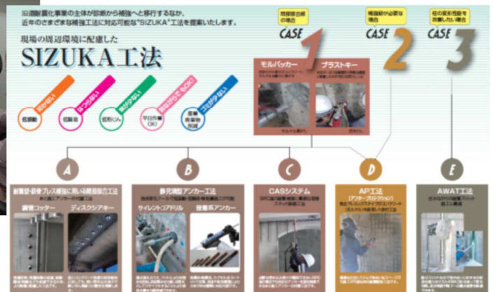
(右) 居ながらの耐震補強工事を見据えた騒音や粉塵が出にくい「SIZUKA工法」
