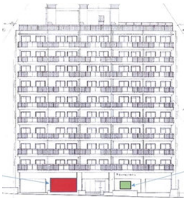
南立面 1階耐震壁・開口閉塞
