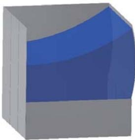
大地震が来ると水槽内の水はスロッシング現象により水槽のパネルを破損させる程大きな波が発生します。
