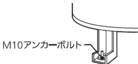
左：電気温水器の脚は、必ず床面のコンクリート躯体へアンカーボルトを用いて固定する。
